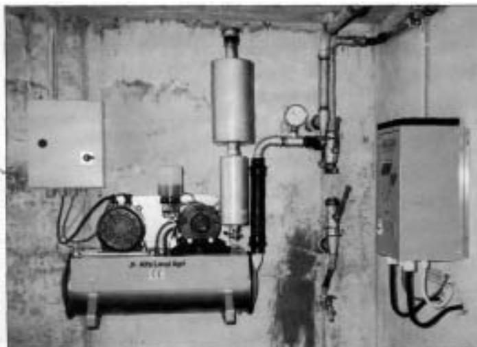
*Ökomelmaschine mit dem Wechselrichter*
