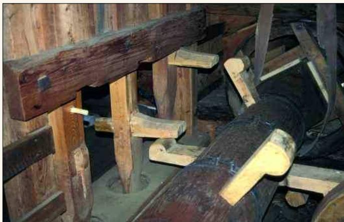
*Mit der Welle werden die Noppen der Stampfer nach oben gehoben und durch das Fallen die Körner gemahlen*
