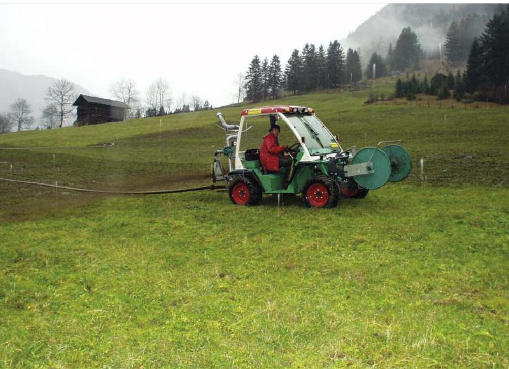
*Die Gülleverschlauchung, welche auch im Berggebiet und Hanglagen immer beliebter wird, hat viele Vorteile. Sie besticht durch hohe Leistung, Bodenschonung und die Möglichkeit, Gülle stark zu verdünnen, was die Ammoniakausgasung stark reduziert.*
