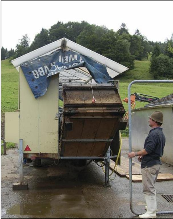
*Der Abbau des Melkstandes ist in 30 Minuten bewerkstelligt. Mit eingebauten Winden werden die Zu- und Abgangsrampen hochgezogen.*
