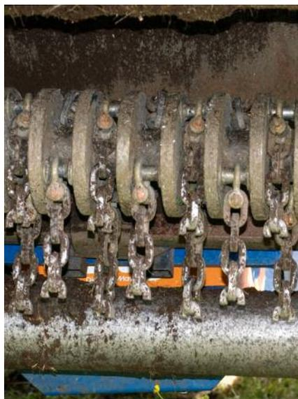
Nach dem Einsatz des Almmulchers muss das Schwendmaterial zur Herstellung eines guten Saatbettes unbedingt von der Fläche entfernt werden (li.). Der Mulchkopf ist mit gehärteten Spezial-Kettenwerkzeugen ausgestattet (re.).
