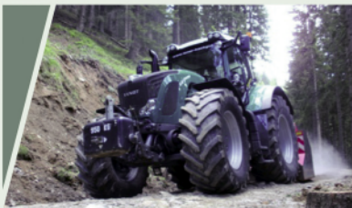
Steinzerkleinerung: Wege-, Straßen- und Flächensanierung
