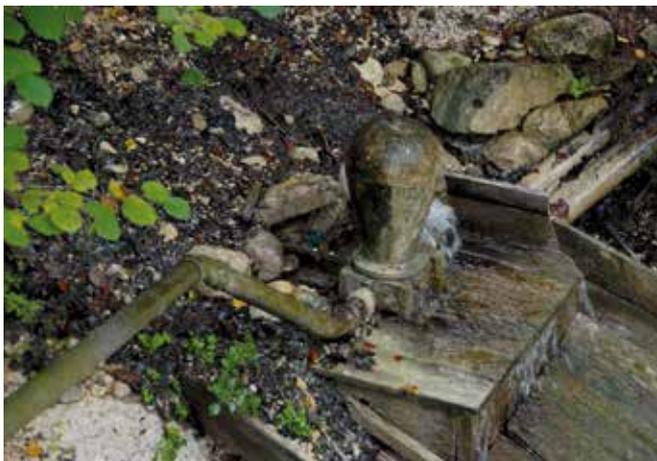
Abbildung 63: Hydraulischer Widder (© Stefan Hellebart)
