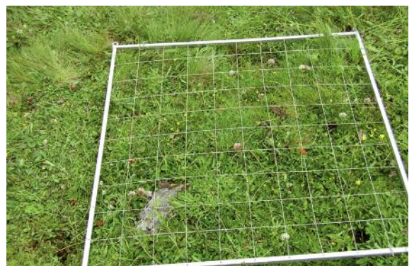
Frequenzrahmen, 1 x 1 m, unterteilt in 100 Teilflächen von 1 dm 2
