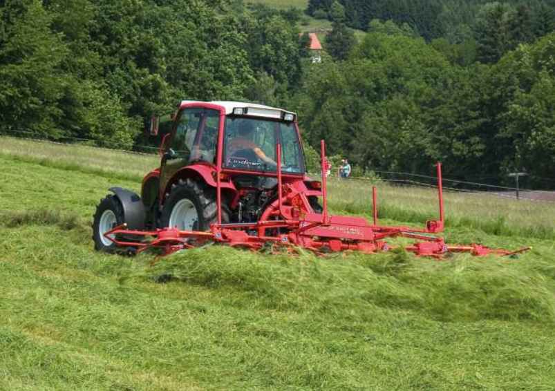
Abbröckelverluste erhöhen sich bei der Futterwerbung durch schnelle Fahrt und hohe Zapfwellendrehzahl.
