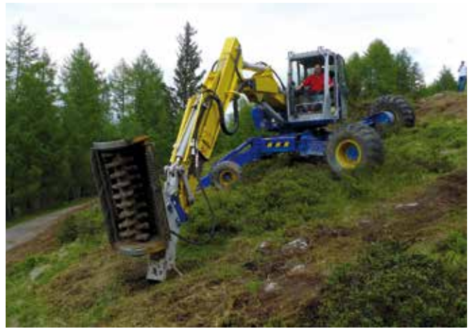
Abbildung 86: Schreitbagger mit Fräskopfaufsatz – der Einsatz schwerer Maschinen sollte kleinflächig und wohlüberlegt erfolgen. (© eb&p Umweltbüro GmbH)
