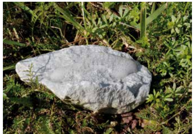
Abbildung 13: Mergel und Kalkstein machen sich nach Beträufeln mit 10%iger Salzsäure durch ein starkes, rasches, sicht- und hörbares Aufbrausen bemerkbar; Dolomite brausen schwach und verzögert auf; Silikatgesteine brausen nicht auf. (© Sonja Keiblinger)
