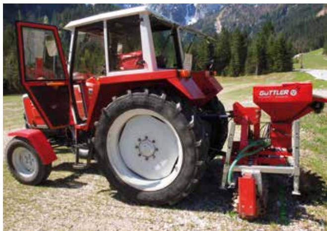
Abbildung 71: Bei befahrbaren Flächen eignen sich Nachsaatgeräte optimal zur Einsaat. (© Bernhard Krautzer)
