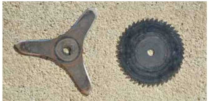
Abbildung 87: Dickungsmesser (li.) und Kreissägeblatt (re.) für Freischneider (© Josef Obwegger)
