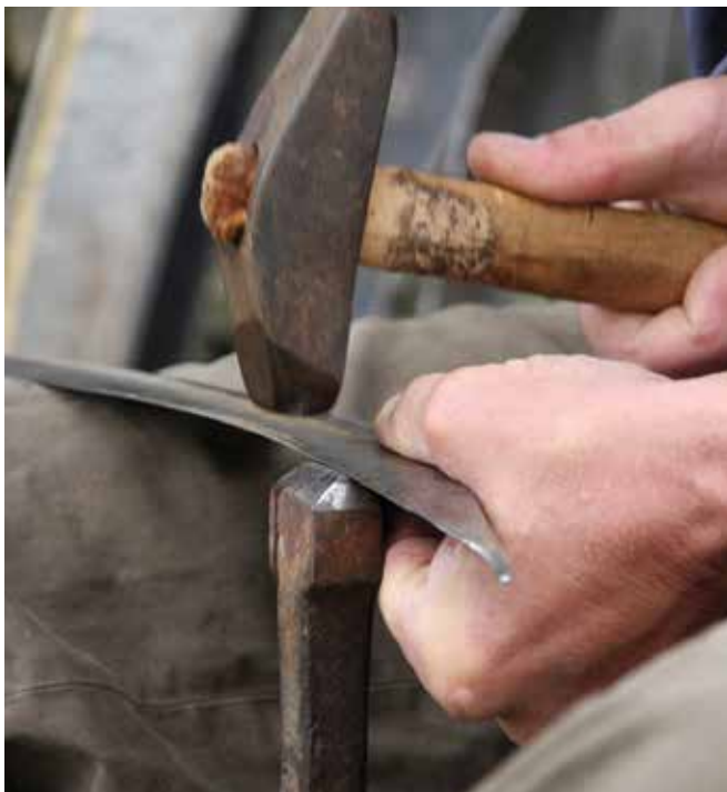
Abbildung 3: Beim Dengeln des Sensenblattes ist Fingerspitzengefühl gefragt. (© Gerhard Mader)
