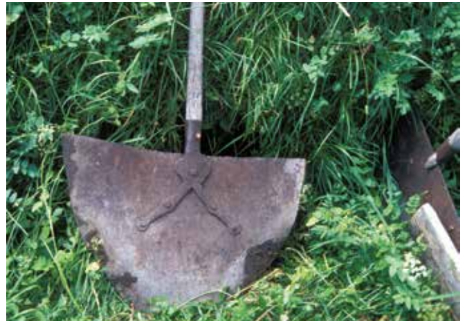
Abbildung 78: Stechschütz oder Wassereisen (© Stefan Hellebart)
