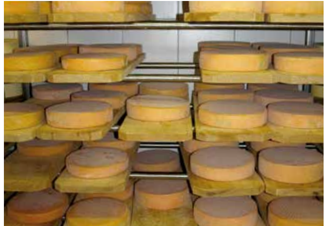
Abbildung 43: Handliche Reifungsbretter und Reifegestelle aus Edelstahl erleichtern die Reinigung. (© Bundesanstalt für Alpenländische Milchwirtschaft)
