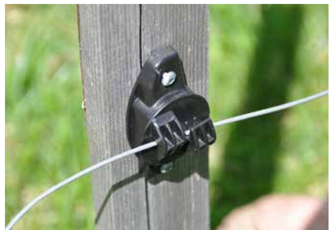
Abbildung 98: Der Isolator sorgt dafür, dass der stromführende Draht keine Verbindung zum Boden hat, es gibt verschiedene Ausführungen – z. B. Isolator aus Kunststoff. (© Barbara Kircher)
