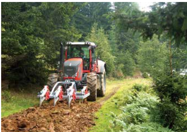
Abbildung 12: Reißzähne bearbeiten eine Weganlage. (© Friedrich Walter Merlin)
