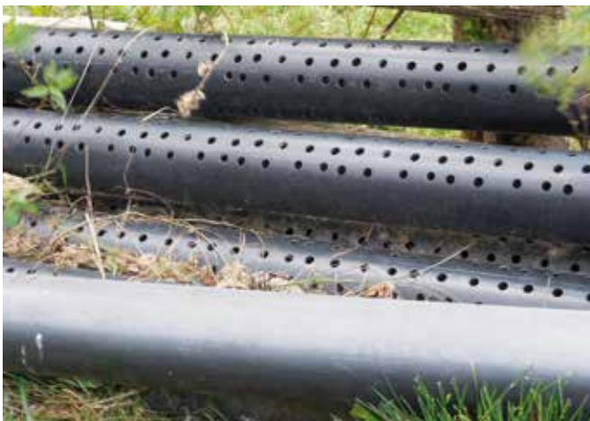
Abbildung 80: Gelochte Kunststoffrohre für die Dränagierung (© Stefan Hellebart)
