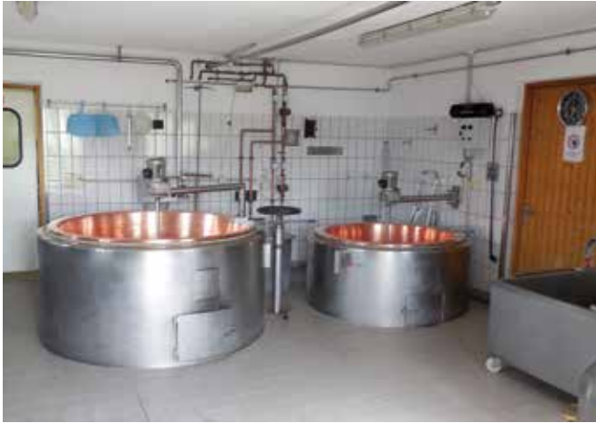
Abbildung 50: Bei den Almsennereien werden die Käsekessel mit Holz beheizt. (© Stefan Hellebart)
