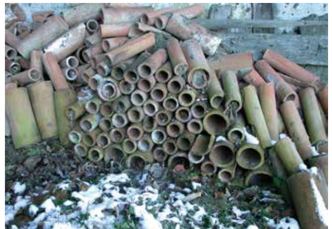
Abbildung 81: Früher wurden zur Dränagierung Tonrohre verwendet. (© Stefan Hellebart)
