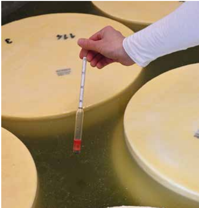
Abbildung 30: Die Salzkonzentration des Salzbadess soll regelmäßig mit einer „Salzbadspindel“ gemessen und anschließend dokumentiert werden (© LK Vorarlberg)
