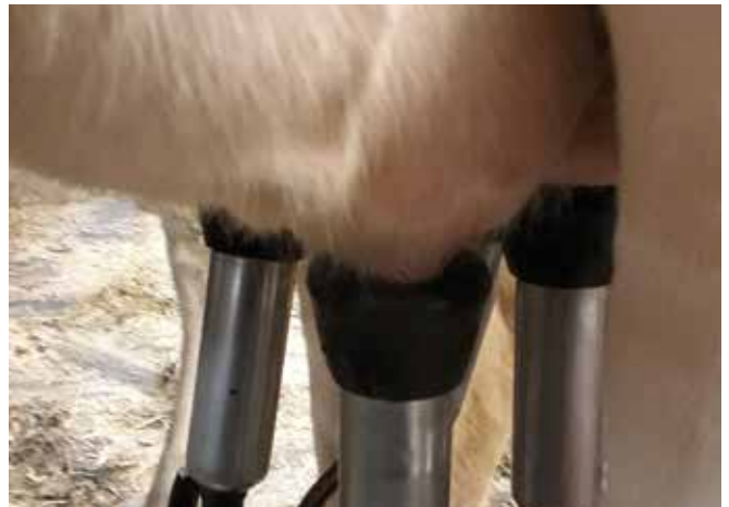
Abbildung 14: Korrekt angeschlossenes Melkzeug (© Lorenz Strickner)
