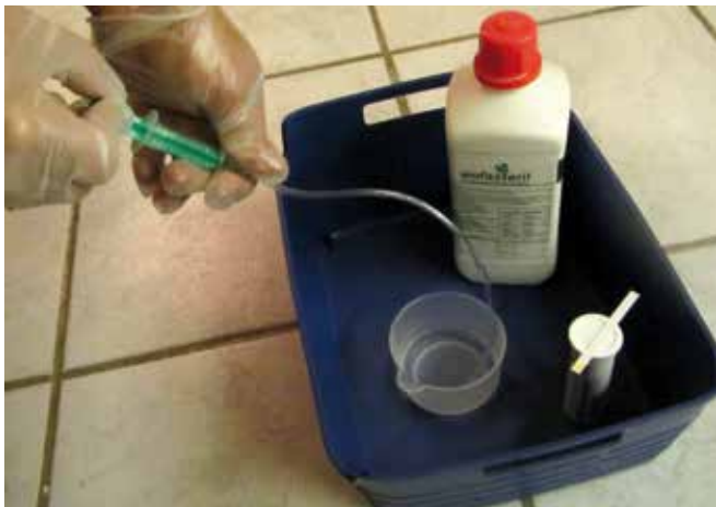
Abbildung 13: Peressigsäure mit Schlauchspritze dosieren, dabei Handschuhe und Schutzbrille tragen (© Kathrin Lincke)
