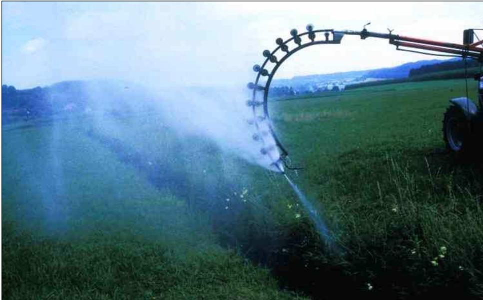
*Der Düsenkopf hat frontal eine Spritzöffnung und Bohrungen, die nach hinten weisen, um den Düsenkopf mit Wasserdruck in die Dränrohre zu treiben*
